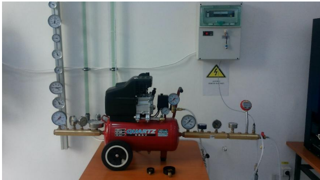
Banc de mesure de pression
